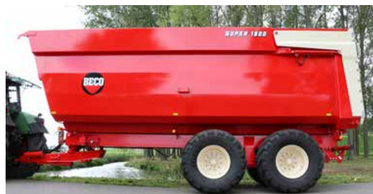
SUPER 1800 XPERT silagekipper. Speciale laadbak 7.000 x 2.250 x 2.200 (34,7 m 2 waterinhoud). De zijwanden zijn uit 1 geheel gemaakt.
