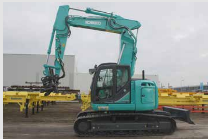
« Example 3 – 2P boom, Kobelco SK230SR
