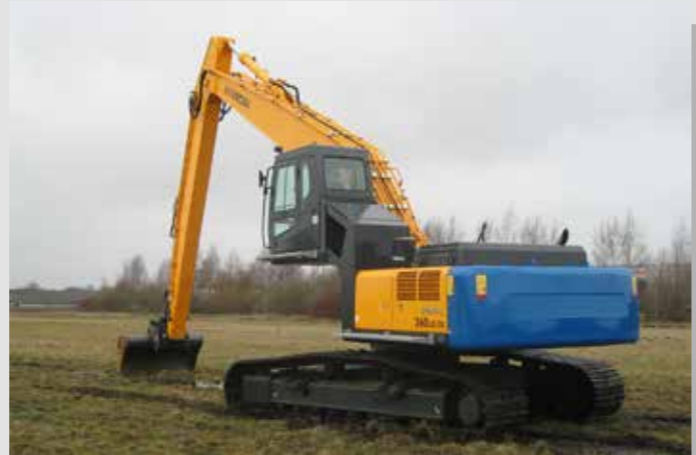
« Example 3 – Hydraulically tiltable cab, Volvo EC300
