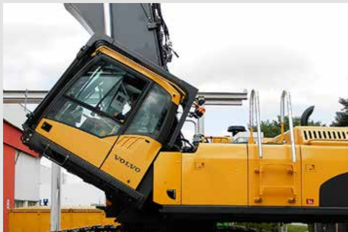
« Example 3 – Hydraulically tiltable cab, Volvo EC300
