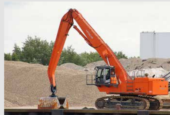
« Example 3 – Material handling front, Hitachi ZX670
